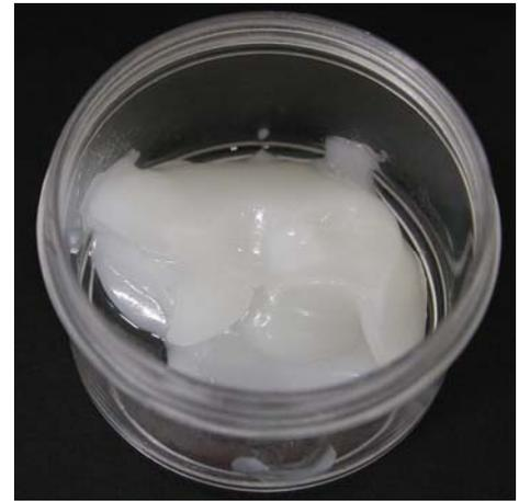
开关等高负荷滑动接点通用的润滑・接触抵抗安定兼备油脂。
